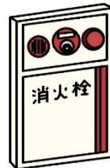
屋内消火栓設備
