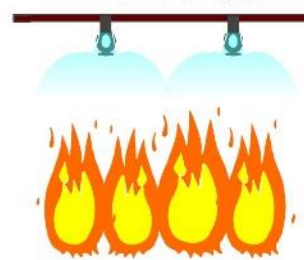
スプリンクラー設備
