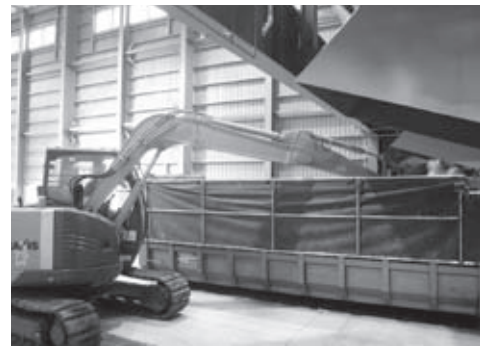
③ 重機で大型コンテナのごみを均等に
