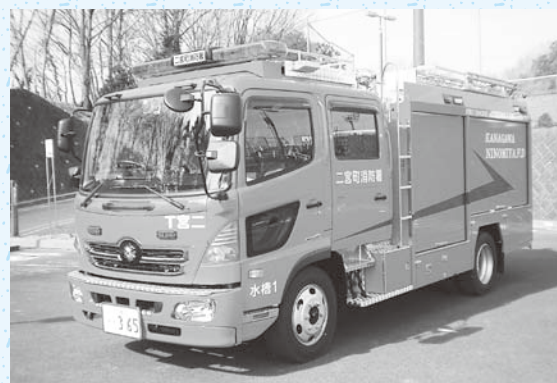
災害対応特殊水槽付消防ポンプ自動車 (放水・給水能力が向上し積載水も利用可能)
