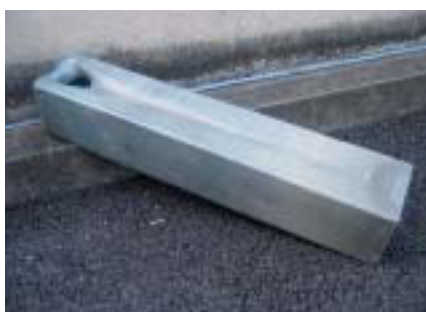
(写真3) 発泡スチロールは、溶かしてプラスチック原料へ
