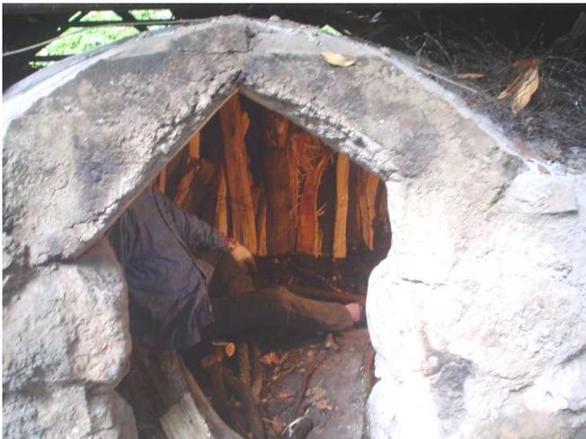
写真は平成12年に山北町の職人により造られた原木の炭焼窯で、竹についてはドラム缶を利用した窯で炭焼を行う。
