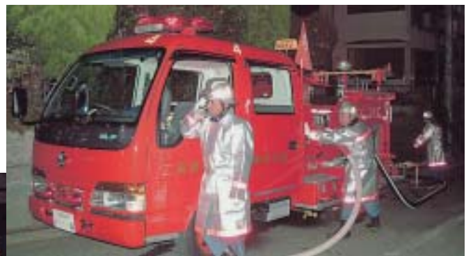
↑ 消火栓を水利にして、筒先(前線)へ送水。
