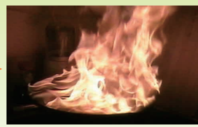
過熱した天ぷら油に火がついた実験映像より
