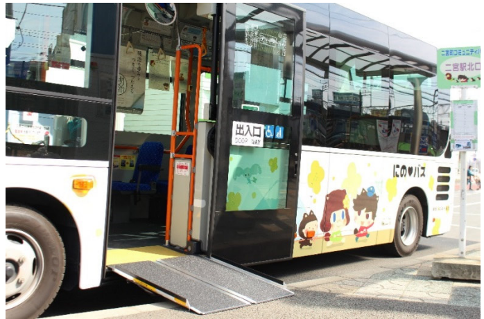
乗降時のスロープ設置で、段差がなくなります
